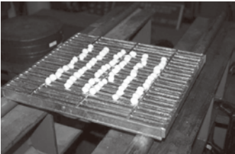
固形物をグレーチングの上にセットします
